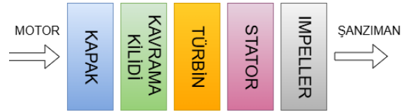
Şekil 1: Tork Konvertörü Diyagramı
