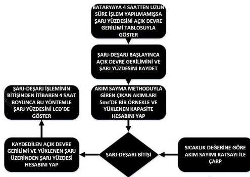
Şekil 7: Şarj kestirim yöntemi akış şeması.
