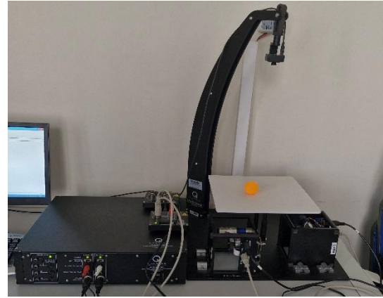
Şekil 1: Quanser 2 Serbestlik Dereceli Top Dengeleyici [8]
