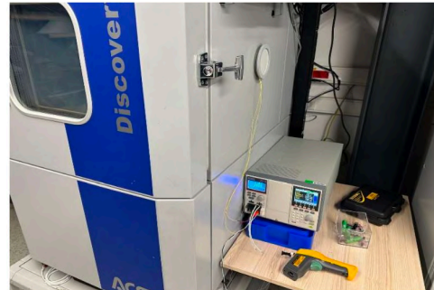
Şekil 6: Düşük sıcaklıkta pil kapasitesi ölçüm düzenneği.
